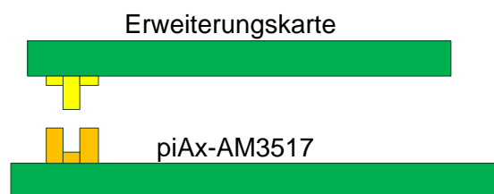
Abbildung 12: Befestigung der Erweiterungsplatinen
